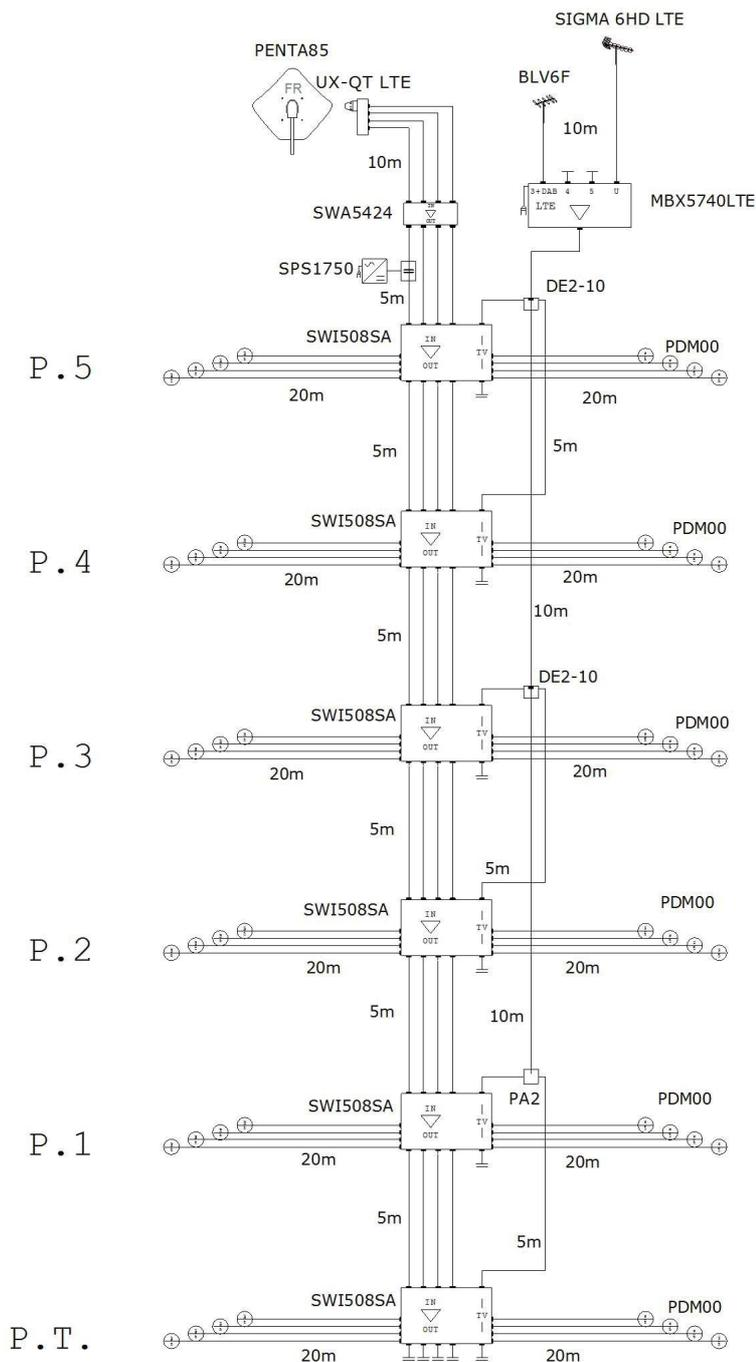
L'indicazione delle antenne, dei supporti porta-antenna e dei preamplificatori da palo nello schema è puramente indicativa, in quanto la scelta dipende esclusivamente dalla tipologia di segnale TV ricevuto nella zona di realizzazione dell'impianto e dalla struttura dello stabile
